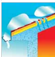
Крыша без вентиляции
