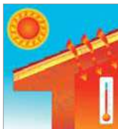
Крыша без вентиляции
