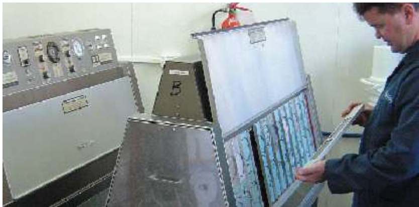
ИСПЫТАТЕЛЬНАЯ СТАНЦИЯ ANI ROOFING ПО УФ ОБЛУЧЕНИЮ
